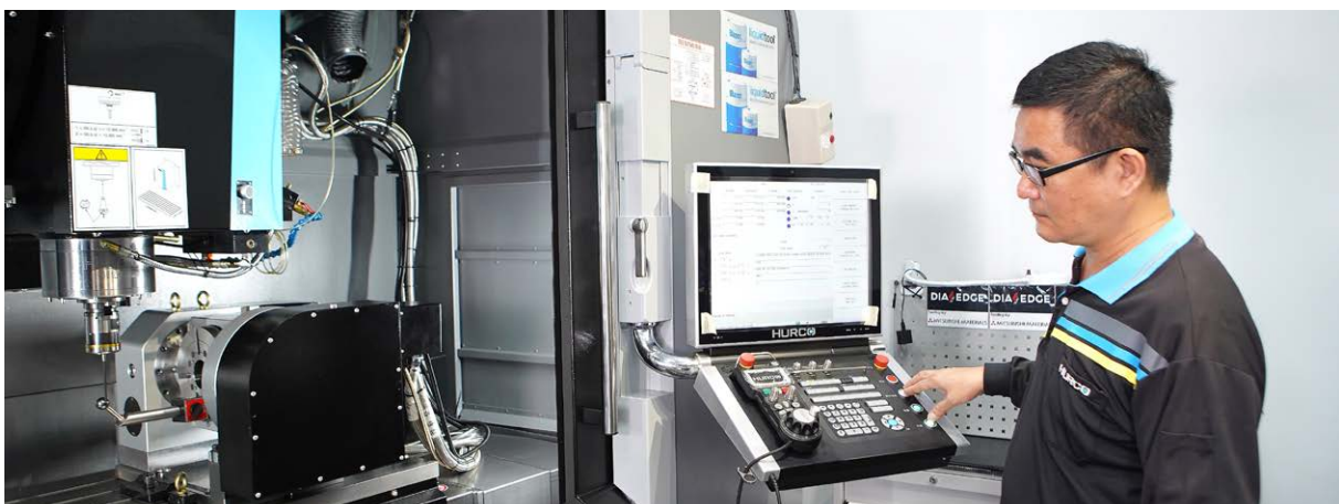
Hurco gebruikt ook de Renishaw RMP600 zeer nauwkeurige schakelende meettaster om producten te inspecteren en bewerkingen in te stellen
