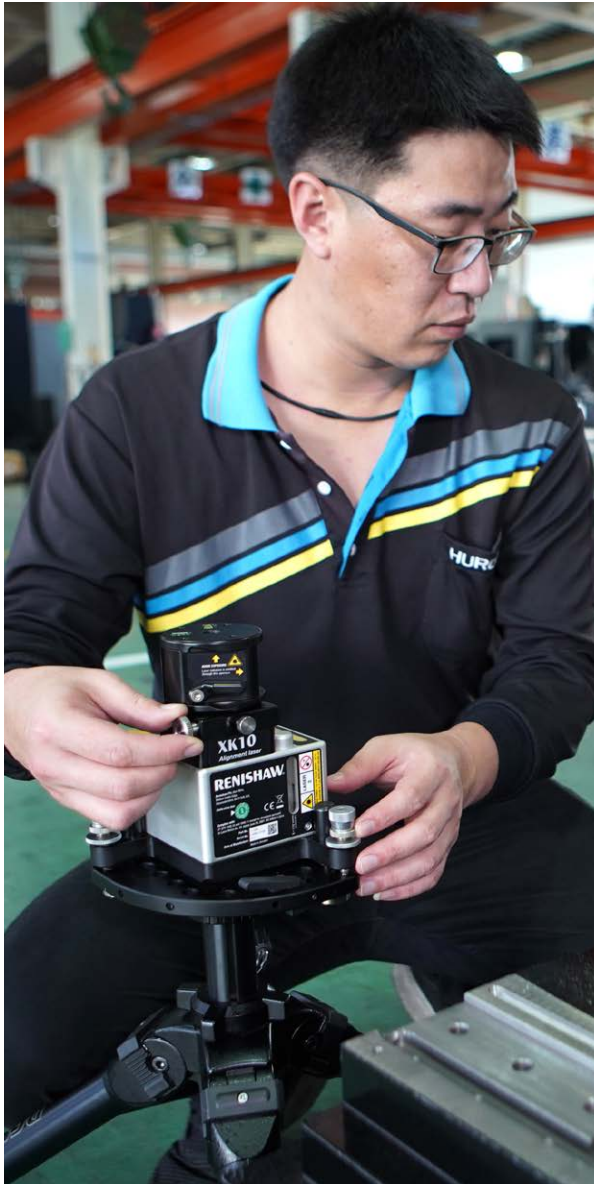
Hurco gebruikt het XK10 lasersysteem voor uitlijning
